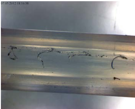
Bild 7: Aufschnitt des PTFE-Schlauches nach 2 Minuten Laufzeit und Abwaschen mit Isopropanol. Es ist gut ersichtlich, dass die Ablagerungen bereits so tief in den Kunststoff eingedrungen waren, dass sich ein Kunststoffspan gebildet hat.
