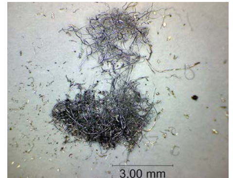
Bild 9: aus dem Schlauch Bild 8 mit Isopropanol ausgewaschene Späne.
