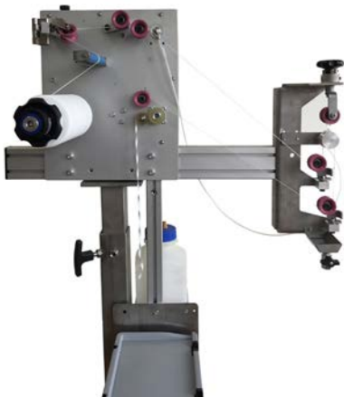
Gleitmittelauftrag & Reinigung mit textilen Bändern (LS-WST)
