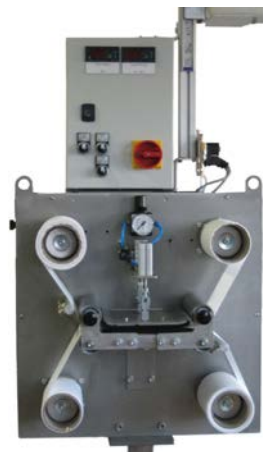
Abstreifen mit textilen Bändern aus Vliesstoff (PWW)
