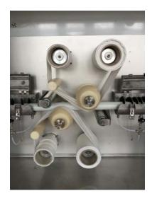
Das KFP-V System dient zur Entfernung von Fehldrucken auf Kabeln im kontinuierlichen Durchlauf. Hierzu wird das Kabel mit einem geeigneten Lösemittel beaufschlagt und in zwei Schritten mechanisch durch Vliesstoffbänder abgestreift.
