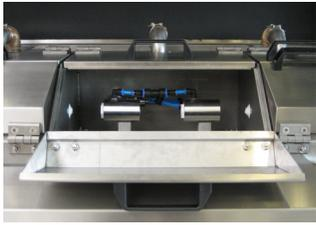
Für die Trocknung von Drähten, Litzen und Kabeln hat GEO eine Edelstahldüse entwickelt, die bei geringem Luftverbrauch auch bei sehr hohen Prozessgeschwindigkeiten optimal trocknet.
