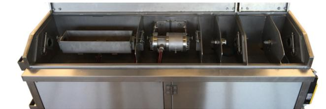
Ölige Rückstände werden durch die hohe Temperatur und kinetische Energie des Dampfstrahls zuverlässig entfernt. Gleichzeitig sorgt der trockene, überhitzte Dampf mit seiner hohen Wärmeübertragung für eine schnelle Trocknung wasserbenetzter Oberflächen.
