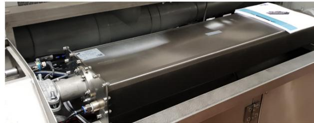
Rohrreaktoren sind in Bezug auf die erzielte Leistungsdichte, bei gleichzeitig kompakten Abmessungen und variablen Einsatzmöglichkeiten, unübertroffen. Das Verfahren basiert auf dem Effekt der Kavitation, konzentriert in einem mit Reinigungsflüssigkeit gefluteten Rohr. In diesem wird das zu reinigende Material über den gesamten Röhrenquerschnitt einem hochintensiven Ultraschallfeld in einer ausgeprägten Fokuszone ausgesetzt. Seifen und Öle werden wirksam entfernt, Beizprozesse unterstützt.
