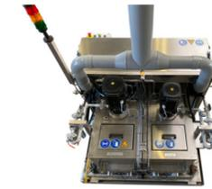
Dampf ist eine weitere Option, um ölfreie Materialoberflächen zu generieren. Die in der Prozesszone eingesetzten Düsen werden singulär oder häufig auch in Kombination mit einer Hochdruckdüse verwendet.
