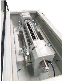
Die Bürstanlage DRB-WCS ist ein kompaktes, umweltfreundliches und kostengünstiges System zur mechanischen Behandlung von runden Materialien im Durchlauf. Hierzu durchläuft das zu reinigende Material eine in einer Rotationseinheit fixierte
