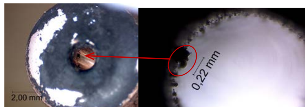
Bild 26: Kupferablagerungen in der Kontaktspitze (liegen in ca. 3 mm Tiefe)
