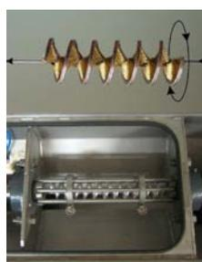
Alternativ zur statischen Anwendung der Bürste hat GEO eine Rotationseinheit entwickelt, in deren angetriebener Aufnahmevorrichtung abgelängte Spiralbürsten eingespannt werden. Durch die Rotationsbewegung werden die gelösten partikulären Verschmutzungen nach außen getragen und in einer Auffangwanne gesammelt. Verbliebene Restverschmutzungen werden abschließend abgeblasen.
