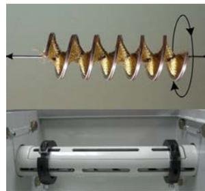
Alternativ zur statischen Anwendung der Bürste hat GEO eine Rotationseinheit entwickelt, in deren angetriebener Aufnahmevorrichtung abgelängte Spiralbürsten eingespannt werden. Durch die Rotationsbewegung werden die gelösten partikulären Verschmutzungen nach außen getragen und in einer Auffangwanne gesammelt. Verbliebene Restverschmutzungen werden abschließend abgeblasen.
