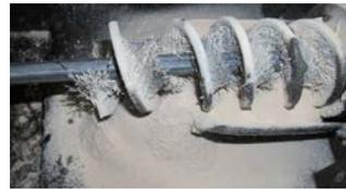
Spiralbürsten mit nach innen gerichtetem Besatz sind ein wirksames Hilfsmittel für einfache Reinigungsaufgaben wie die Entfernung von Zunderresten, Pulverziehmitteln und Staub. Die von GEO angebotenen Spiralbürsten in Edelstahlfassung sind in einer Vielzahl von Durchmesser und Besatzmaterialien erhältlich. Der nach innen gerichtete Besatz ist in der Regel überlappend ausgeführt. Bürstendurchmesser und Besatzstärke bestimmen den Härtegrad.
